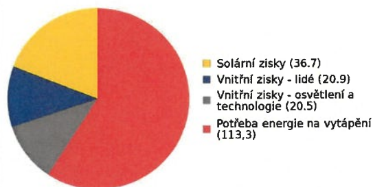
Bilance potřeby energie na vytápění (MWh/rok)
